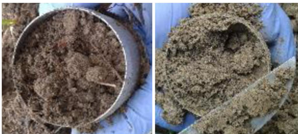
Se a parte em falta no anel metálico for superior a 10%, descartar o solo e retirar outra amostra no lado oposto do buraco, seguindo os mesmos passos descritos anteriormente.
