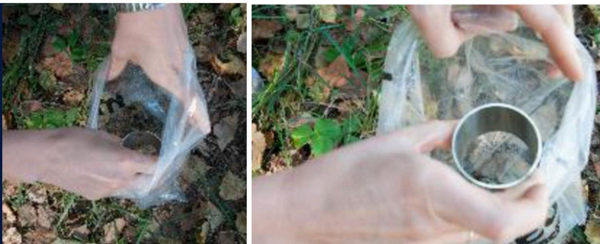
Do ponto Central referenciado, caminhar **2 m para Norte** e repetir os passos para a colheita de nova subamostra. Quando terminado, caminhar para **Este**, para o ponto marcado e repetir a operação de colheita de outra subamostra de solo. **Depois caminhar para Sul e de seguida para Oeste**, repetindo a operação.
