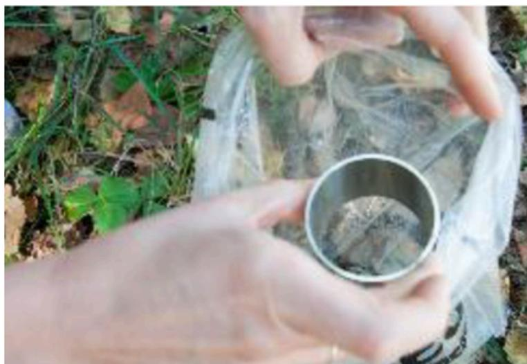
Do ponto Central referenciado, caminhar **2 m para Norte** e repetir os passos para a colheita de nova subamostra. Quando terminado, caminhar para o ponto **Este**, para o ponto marcado e repetir a operação de colheita de outra subamostra de solo. **Depois caminhar para Sul e de seguida para Oeste**, repetindo a operação.
