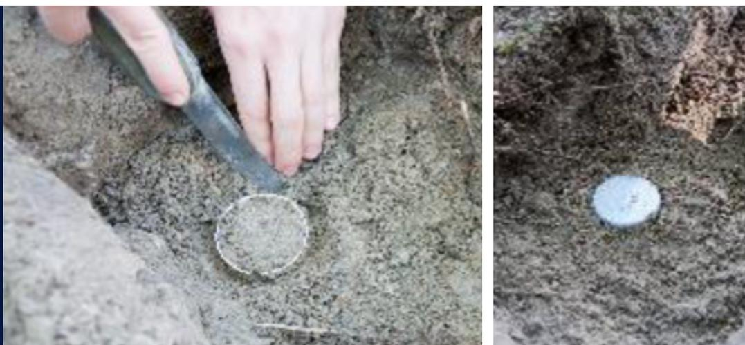
Escavar à volta do topo do anel com a espátula, colocar a pá (ou a pá de jardinagem ou a colher de pedreiro) por baixo do anel e remover cuidadosamente.
