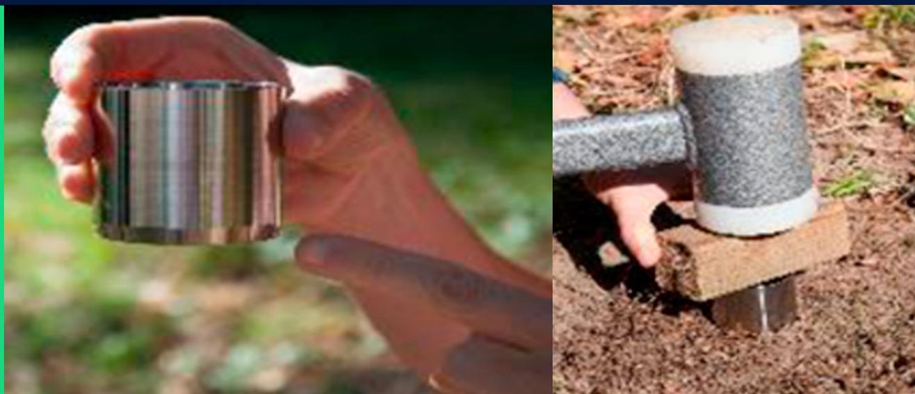
Escavar um pouco à volta do anel com a faca e colocar a tampa plástica no anel.
