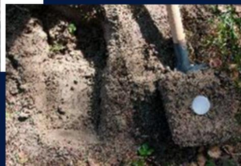
Com a faca/espátula, remover o excesso de solo da base e à volta do lado exterior do anel.
