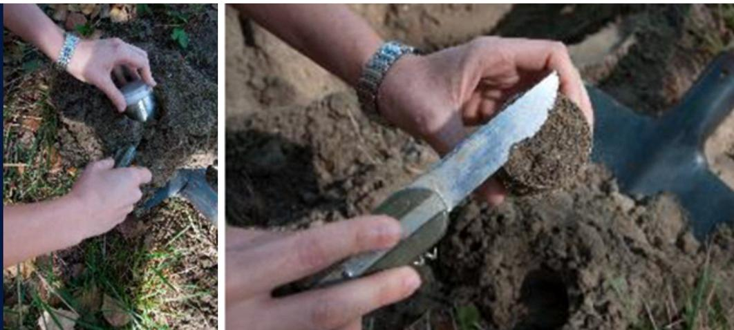
Se o anel metálico não estiver completamente preenchido de solo (menos de 10% em falta devido à presença de uma pedra ou à perda de material no momento da sua remoção do solo), pode-se completar o anel com solo removido correspondente à devida profundidade.
