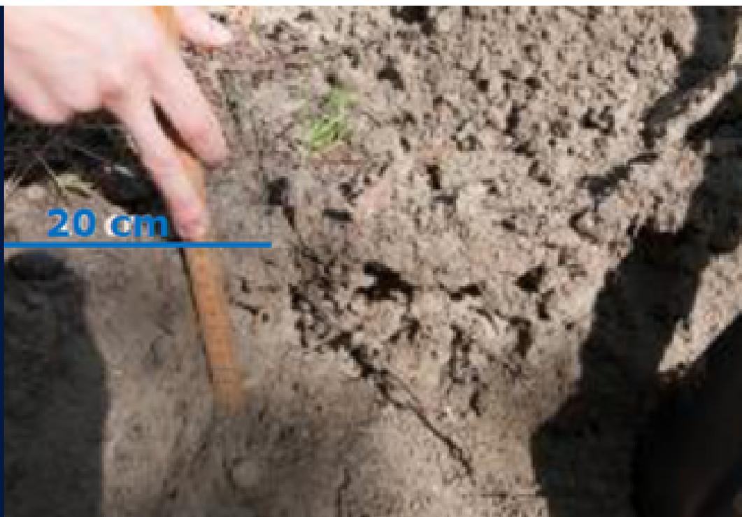
Com auxílio da régua de aço inox, medir a profundidade do buraco onde foi colhida a primeira amostra. Se a profundidade do buraco for inferior a 20 cm, escavar para atingir essa profundidade.
