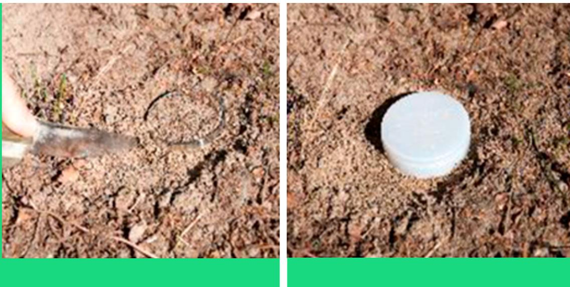
Escavar um buraco, fazendo 4 cortes com a pá, à distância de pelo menos 2-3 cm, evitando pisar o local onde o anel está inserido. Em **alternativa**, o buraco pode ser aberto com o auxílio de um perfurador de solo.
