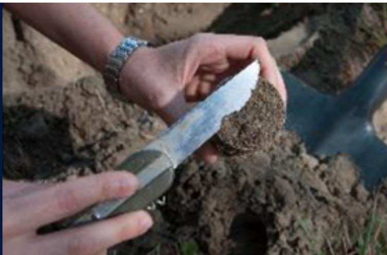
Com a faca/espátula de 3 cm, remover o excesso de solo da base do anel e à volta do lado exterior do anel.
