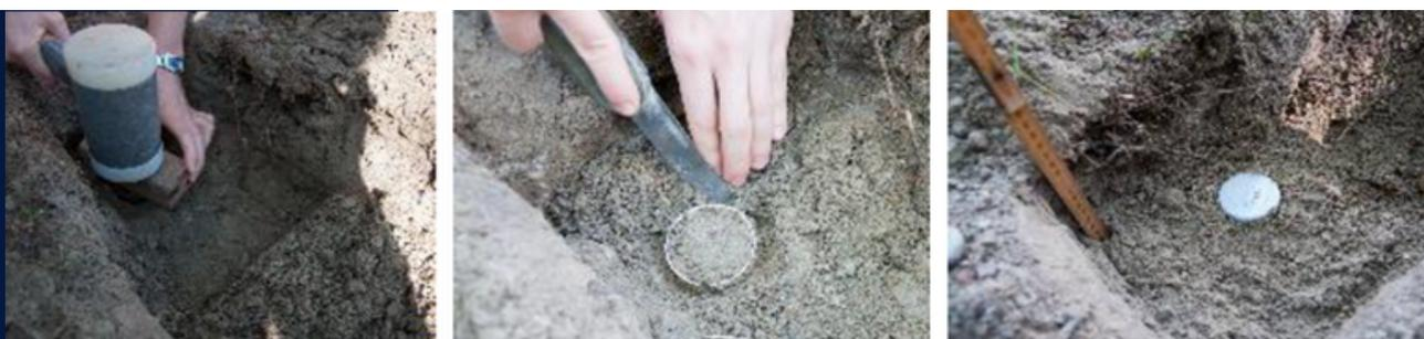
Escavar à volta do topo do anel com a espátula, colocar a pá (ou a pá de jardinagem ou a colher de pedreiro) por baixo do anel e remover cuidadosamente.
